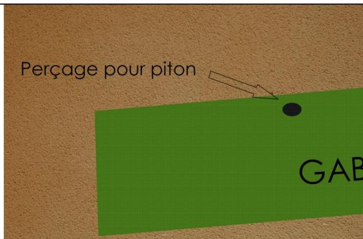
Positionner le gabarit de perçage sur le mur à l'aide de ruban adhésif de manière à pouvoir tracer l'emplacement des perçages.
